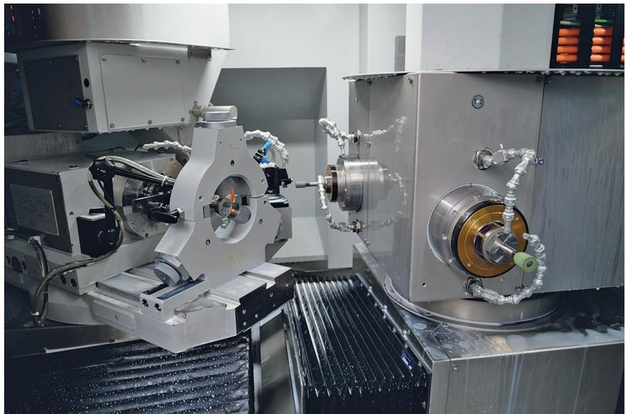
**3** Der flexible Spindelstock der Voumard 1000 ist mit einer Außenschleifspindel und zwei Schnellfrequenz-Innenschleifspindeln ausgestattet © Kellenberger/Jäger
